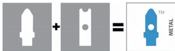
Figura IV.4.8 - Encaixes “T”, “U” e Unificado, respectivamente.
