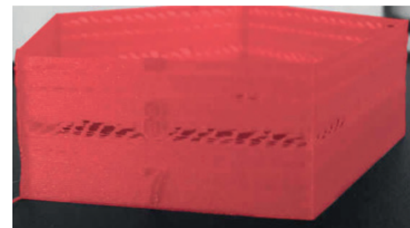
Figura IV.2.20 - Sub-extrusão. Fonte: Prototipando (2020)
