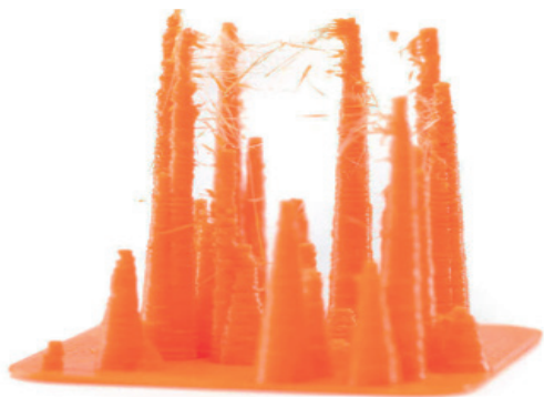
Figura IV.2.21 - Stringing. Fonte: Combtech
