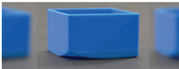
Figura IV.2.18 - Warping (empenamento). Fonte: Tech CD notícias (2021)
