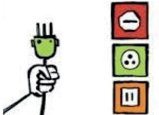
Figura V.3.4 – Exemplo de um Poka Yoke (tipologia tomada)
